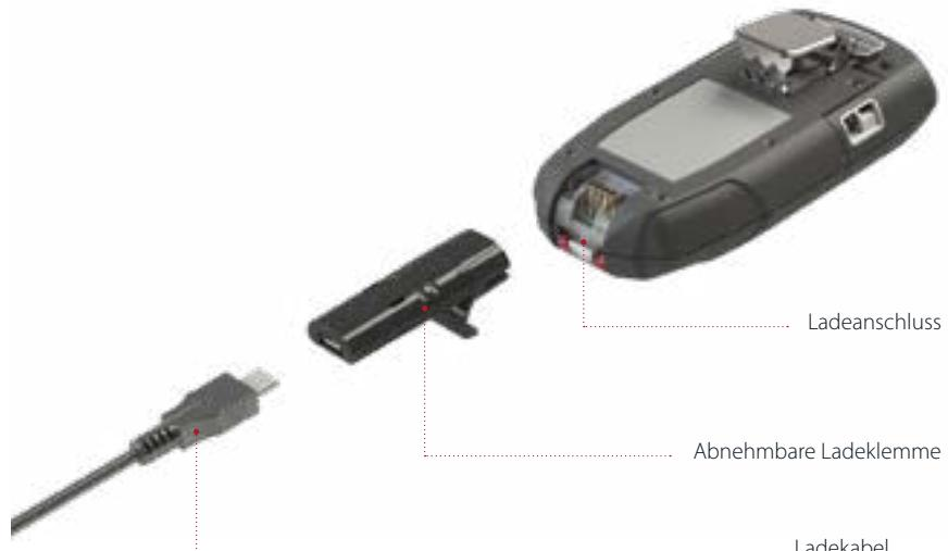
**HINWEIS:** Wenn Ihr Gerät an einen G7 PowerPack angeschlossen ist, schieben Sie die Ladeklemme einfach in den Ladeanschluss des PowerPack. Der PowerPack und der G7 werden gleichzeitig aufgeladen.
