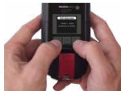
Rote Alarmsignale werden umgehend an das Überwachungspersonal weitergeleitet. Lesen Sie die Hinweise auf Ihrem G7-Display. Halten Sie die Auf- und Ab-Pfeiltasten gleichzeitig gedrückt, um den Ton und die Vibrationen stumm zu schalten. Dadurch wird der an das Überwachungspersonal gesendete rote Alarm nicht abgebrochen.
