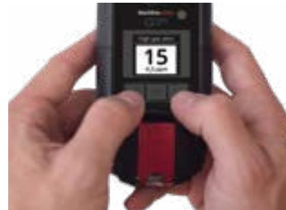
Verlassen Sie den Bereich und befolgen Sie das Notfall-Sicherheitsprotokoll. Lesen Sie die Hinweise auf Ihrem G7-Display. Halten Sie die Auf- und Ab-Pfeiltasten gleichzeitig gedrückt, um den Ton und die Vibrationen stumm zu schalten. Signaltöne und Vibration kehren nach einer Minute wieder zurück. Dieser Vorgang setzt sich fort, bis die Gasmengen oder Durchschnittswerte gesunken sind oder wieder akzeptable Konzentrationen vorliegen.
