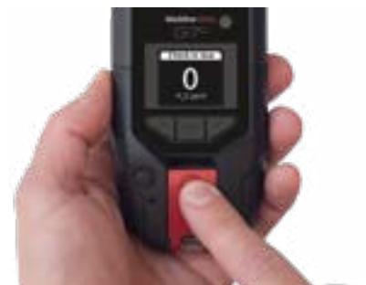
Wenn Sie in Sicherheit sind, drücken Sie die rote Hebeltaste. Wenn Sie die Hebeltaste nicht innerhalb der konfigurierten Zeit drücken, gibt ihr gelbes Rückmeldesignal einen roten Alarm an das Überwachungspersonal weiter.
